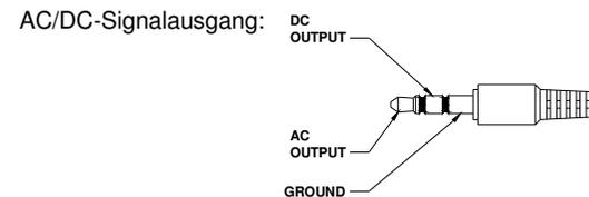
AC: Ausgangsspannung: 1Vrms entsprechend jedem Bereichsschritt.
