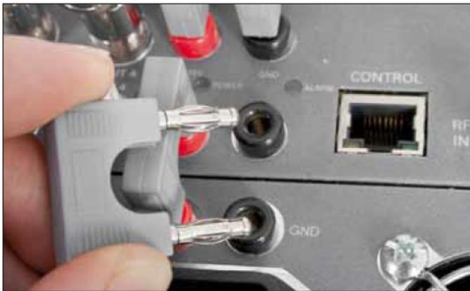
Steckbrücken verbinden die beiden Module untereinander. Sollen diese unabhängig betrieben werden, ist auch ein Entfernen der Brücken möglich
