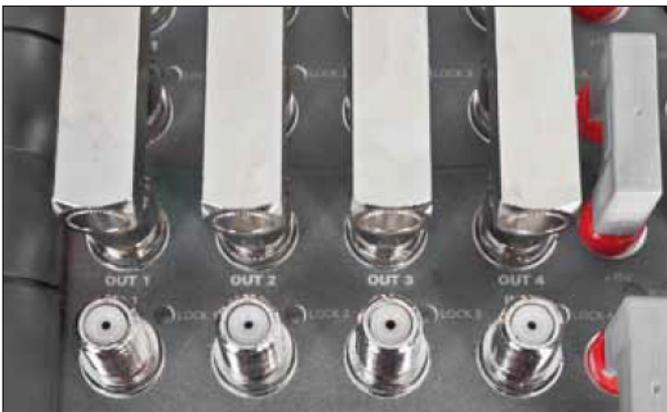
Vier Satelliteneingänge stehen an der Kopfstelle zur Verfügung. Diese werden 1:1 auch an das zweite verbaute Modul weitergegeben, die Brücken können jedoch auch entfernt werden
